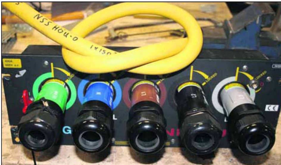
Figuur 5.1 het aansluitblok van het 400A powerlock systeem
